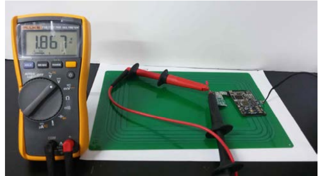
그림 3. 스마트위치용 6.78 MHz 자기공진형 무선전력전송 시스템 전 송효율 측정 환경 및 측정 결과
